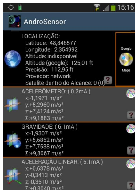
Figura 2: Exemplos de sensores disponíveis em um smartphone. Fonte: Software AndroSensor 3 .
